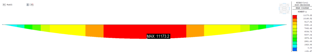
Rysunek 4. Moment zginający M_y od maksymalnej kombinacji obliczeniowej ULS.
