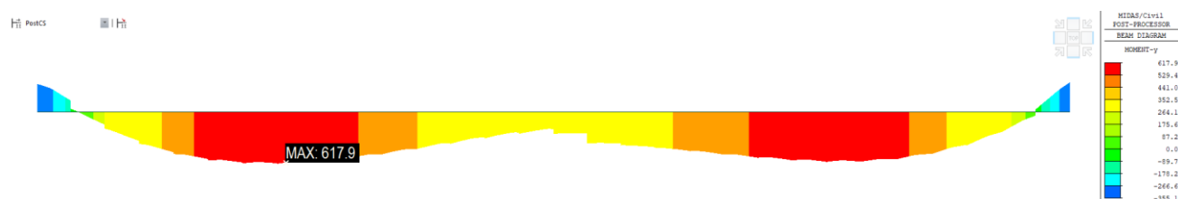
Rysunek 6. Moment zginający M_y od maksymalnej kombinacji częstej SLS_freq.
